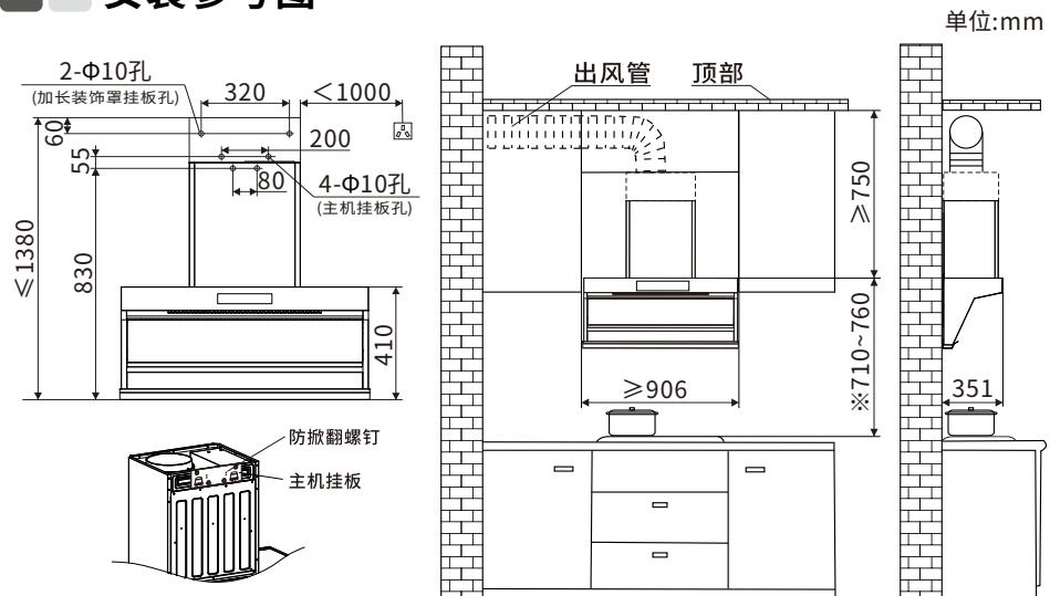
※ 此安装尺寸只适用于电灶，如果安装在燃气炉灶上方，炉灶上烹调器具的支承面与吸油烟机最低部位的最小距离应至少为65 cm。如燃气炉灶安装说明规定了较大的安装距离，则对此应予考虑。当本产品的安装高度(即炉灶上烹调器具的支承面与吸油烟机最低部位的距离)低于65 cm时(吸烟效果更好)，低于65 cm部分的所有部件均为吸油烟机的不易燃部件或工作在安全特低电压下的部件，且这些部件变形时，不会影响对触及带电部件的防护。
