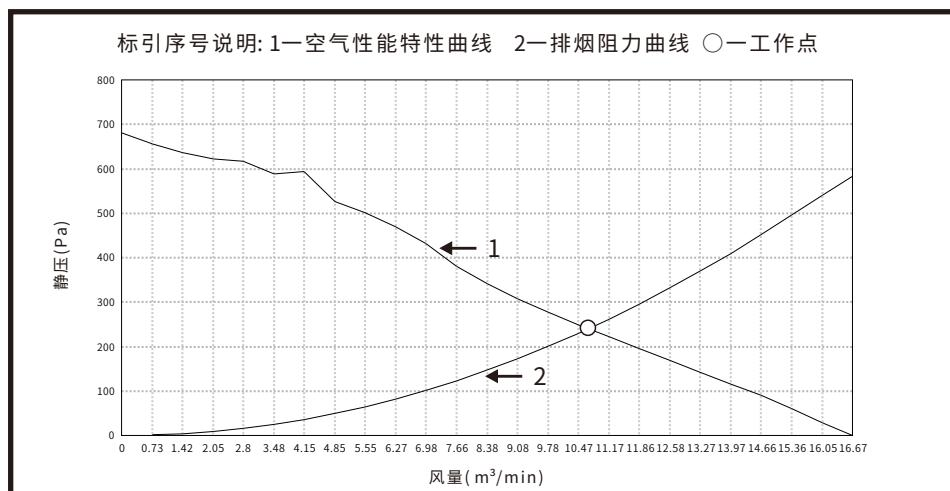
注：1.空气性能特性曲线与排烟阻力曲线的交点所对应的风量即为工作风量。
